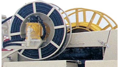
Предлагаемая в качестве опции система катушечной намотки для силового кабеля и водяного шланга облегчает их развертывание / свертывание, значительно экономя при этом время.
