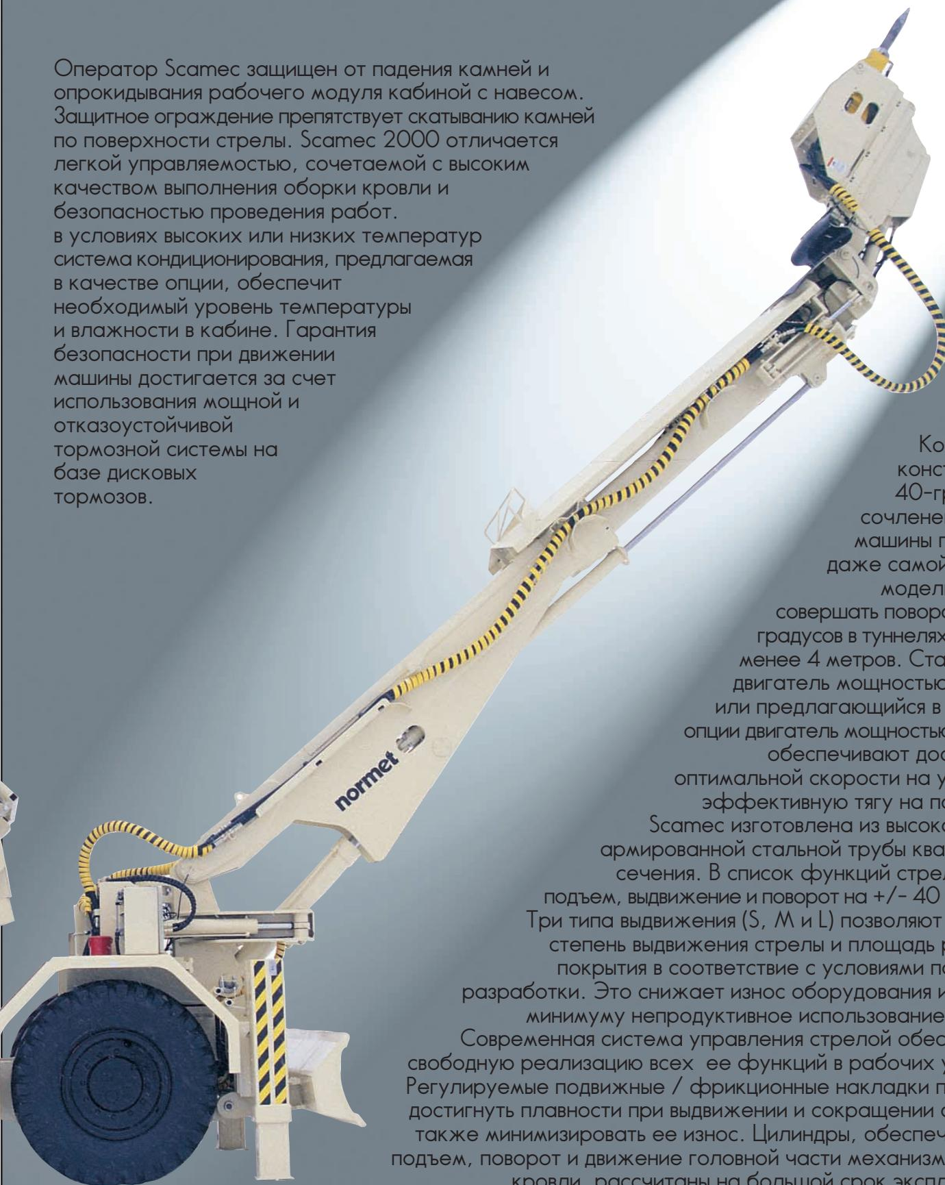
Компактная конструкция и 40-градусное сочленение рамы машины позволяет даже самой длинной модели Scamec совершать повороты на 90 градусов в туннелях шириной менее 4 метров. Стандартный двигатель мощностью 115 кВт или предлагающийся в качестве опции двигатель мощностью 154 кВт обеспечивают достижение оптимальной скорости на уклонах и эффективную тягу на подъемах.
