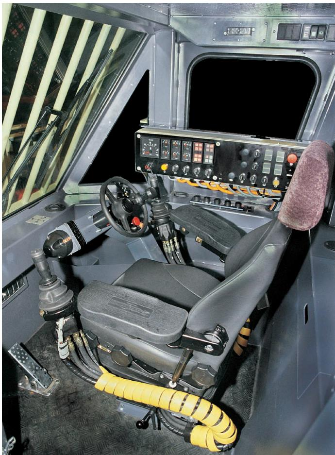
Специально сконструированная кабина оператора обеспечивает комфортные рабочие условия. Из эргономичного, снабженного всеми видами регулировок кресла оператору доступны органы управления, как стрелой, так и самой машиной. При этом органы управления удобно расположены в пределах вытянутой руки. Благодаря отсутствию препятствий в поле зрения оператора и мощному световому оборудованию при выполнении работ
